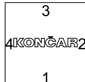
Pogled X - Priklučni ormarić, položaj uvednica View X - Terminal box, cable gland position
