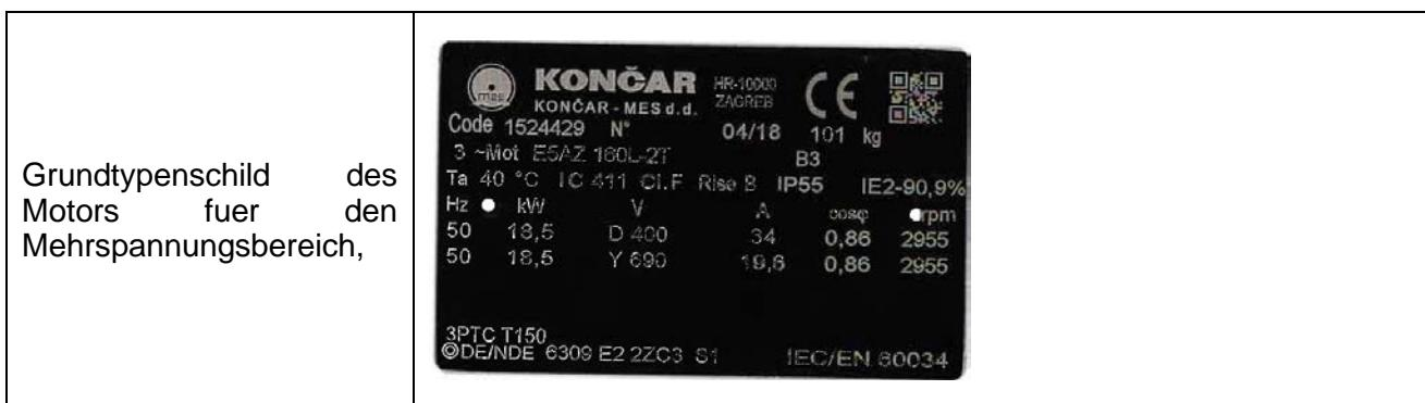
Bei den Motoren versehen mit dem Typenschild für den Mehrspannungsbereich oder bei Motoren wo solches Typenschild auch benutzt wird (Ex d(e) Motoren für den Antrieb über den FU-Betrieb S9)- schreibt man die Daten bestimmter Drehzahlen und die zugehörige Nenndaten
