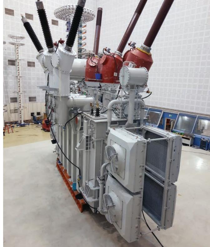
tehnicičku specifikaciju koju stari transformatori ne zadovoljavaju, kao što su definirana veća temperatura okoline +55 °C, odvojeno ulje u uljnim kupolama, odvojeno ulje sklopki, preopterećenja te vrlo mali opseg tolerancije na garantiranu impedanciju (-0 % / +7,5 %).
