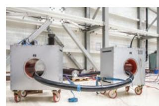
Ispitivanje visokonačenskog energetskog kabela nazivnog napona 66 kV za inozemnog naručitelja. Iako nije poseban izazov za ugradenu ispitnu infrastrukturu, pamtić će se kao prvi posao i referenca novog laboratorija
