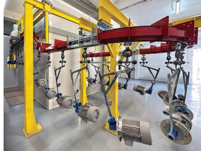
KONČAR – Motori i električni sustavi (MES) završili su investiciju u novu suvremenu lakirnicu u cilju poboljšanja kvalitete i produktivnosti. Lakirnica se sastoji od tri kabine od kojih su dvije za ličenje motora te jedna za ličenje dijelova motora. Novom lakirnicom MES u potpunosti može zadovoljiti sve strože zahtjeve svojih kupaca u pogledu zaštite od korozije, estetike i posebnih RAL boja, istovremeno zadovoljavajući sve međunarodne smjernice i ekološke standarde.
