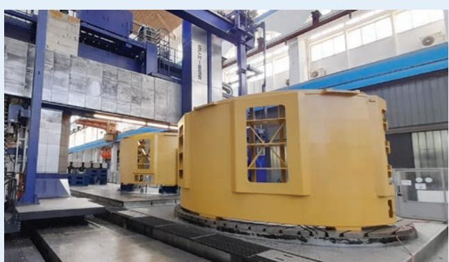
Kućišta su dvodijelna te se polovine zasebno izrađuju sve do trenutka završne strojne obrade kad se kućište spaja i centriraju na CNC stroj. Prvo kućište je prošlo faze pripreme, zavarivanja i pripadajuće kontrole kupca te se trenutačno nalazi na strojnoj obradi koja se, s obzirom na gabarite i masivnost kućišta, održava na CNC obradnom centru Schiess Vertimasteru.
