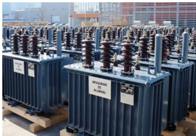
Transformatori na Skladištu gotove robe
