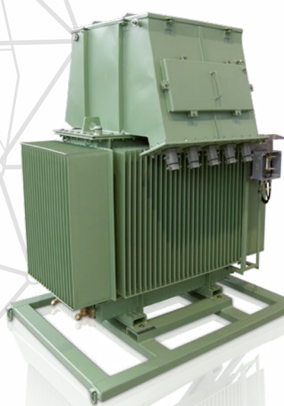
STÖT- OCH VIBRATIONSRESISTENTA TRANSFORMATORER Typ: TBN1000-12/I, Tyskland Märkeffekt: 1000kVA Märkspänning: 6000/400V
