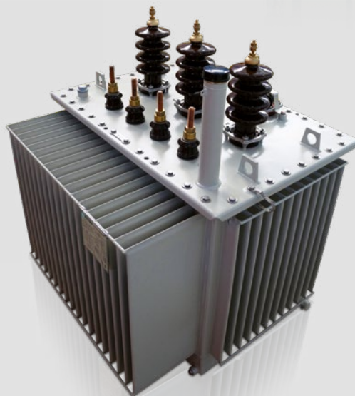
JORDNINGSTRANSFORMATORER OCH REAKTORER I EN GEMENSAM TANK Typ: TBN440-24, Finland Märkspänning: 20500/410V Märkspänning: 5-7.5-10-12.5-15A
