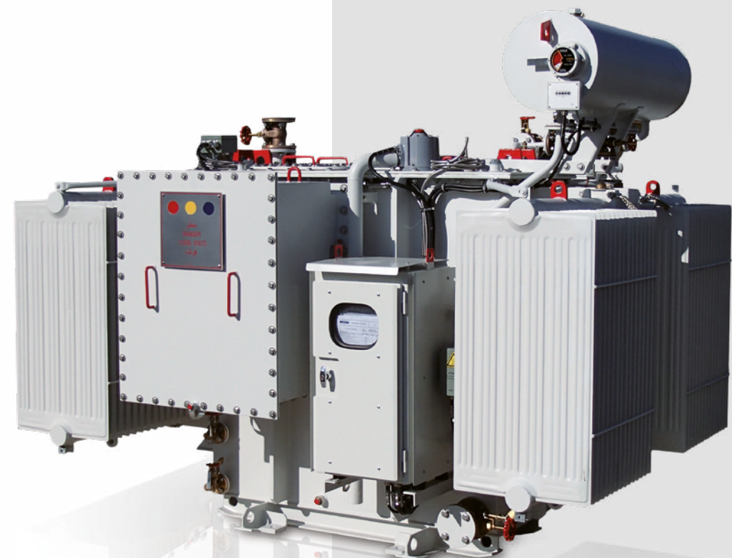
JORDNINGS-/HJÄLPTRANSFORMATORER Typ: TBN1980-36, Qatar Märkeffekt på hjälplindning: 800kVA Märkspänning: 33000 ± 2x2,5 %/433V
