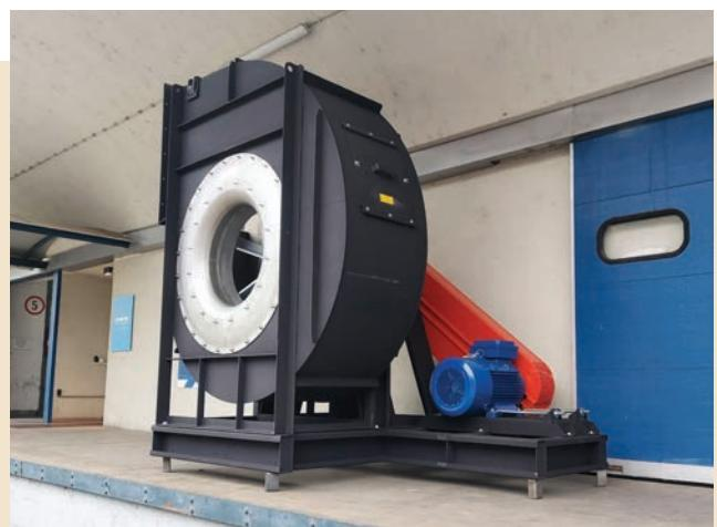
denih razloga kućište ventilatora izvedeno je od nehrđajućeg čelika AISI316, a rotor ventilatora od HARDOX lima otpornog na trošenje što čini razliku od prijašnje izvedbe s čeličnim kućištem i rotorom.
