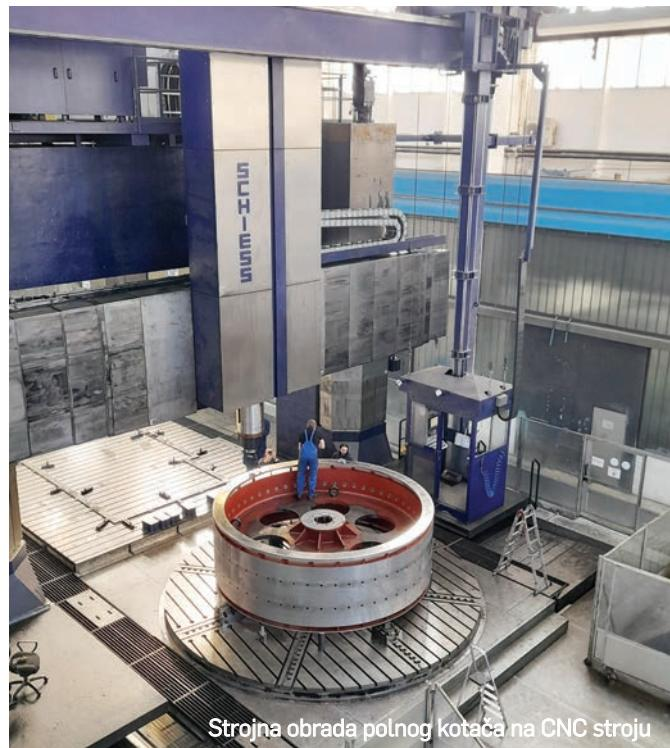
Strojna obrada polnog kotača na CNC stroju
