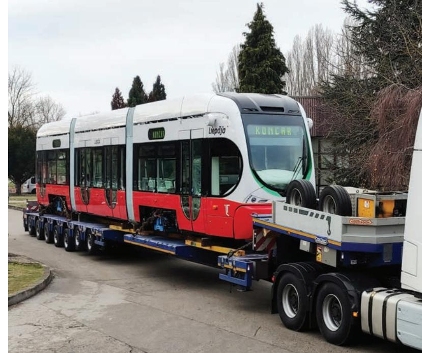
Tramvaji su zasnovani na suvremenom tehničkom rješenju i dizajnu, razvijeni su i proizvedeni u Grupi KONČAR, klimatizirani, opremljeni video nadzorom i sustavom informiranja putnika. Opremljeni su i upravlјivim hidro-pneumatskim sustavom ogibljenja, što omogućuje i podešavanje visine poda ovisno o stanju na pruzi te prilagođena osobama s poteškoćama u kretanju.
