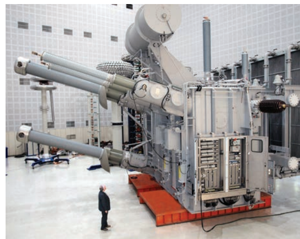
HVDC transformator za Novi Zeland
